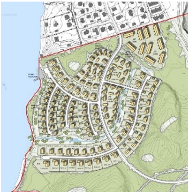
Kuva 13. VE 2: "Keskisuuret tontit". Alueelle on sijoitettu alustavasti 76 AO-tonttia ja viisi AP-korttelialuetta. AO-tonttien keskipinta-ala on liki 700 m 2 , rakennusoikeus alueella yhteensä noin 20 500 k-m 2 .
