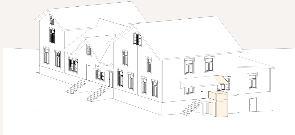
Kuva 152. Esimerkkikaaviot ja aksonometriakuva ulkohissiratkaisusta ja sen vaikutuksista sisätiloihin Rungon ulkopuolinen rakenne pohjoissisäänkäynnin yhteyteen olisi todennäköisesti helpoin hissiratkaisu. Yhteys varsinaiseen pääsisäänkäyntiin ei nykyisellään toteudu, mutta sisätiloihin vaaditut muutokset sen toteuttamiseksi ovat maltillisia. Ulkoisella hissillä esteetön kulku on mahdollista järjestää vain ensimmäiseen kerrokseen.
