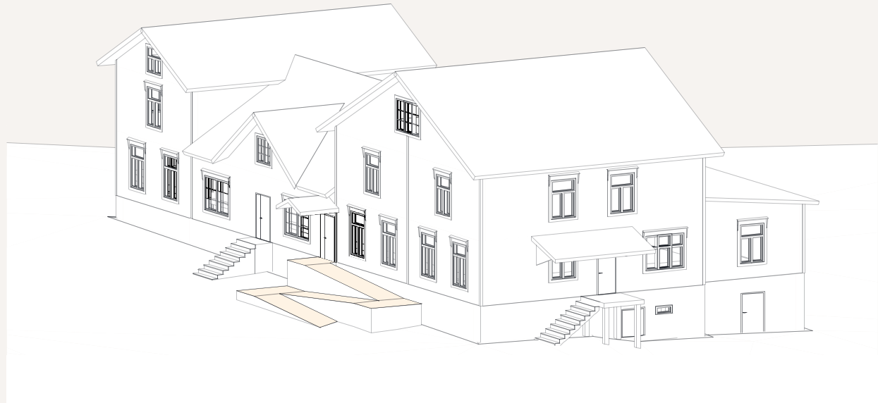
Kuva 151. Esimerkkikaaviot ja aksonometriakuva ramppiratkaisusta ja sen vaikutuksista sisätiloihin
