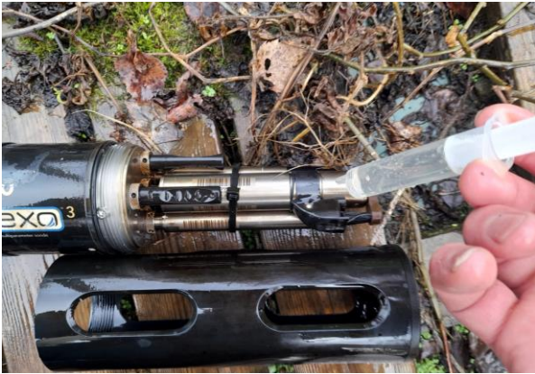
Kuva 25. Jatkuvatoimisen YSI EXO -laitteen puhdistusta (LUVY / Erkka Laitinen)
