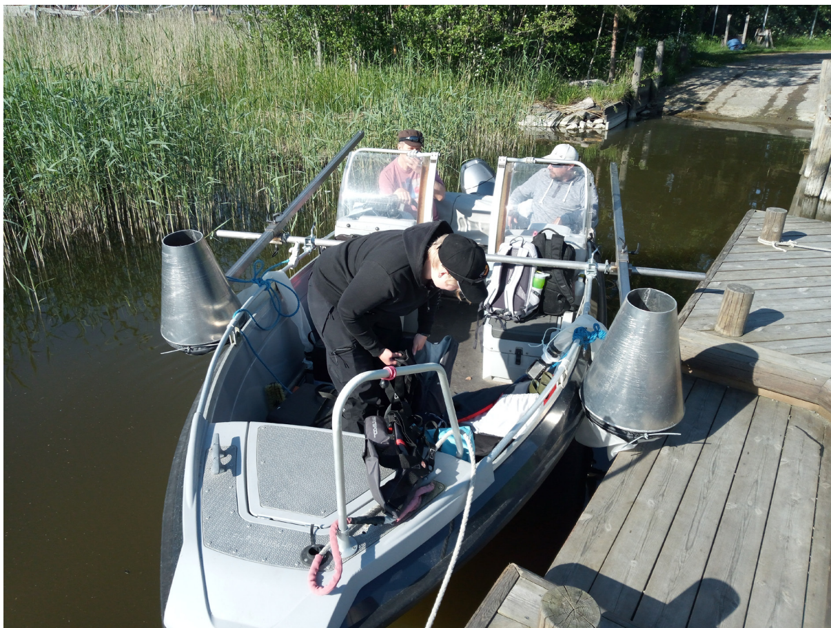
Kuva 3. Gulf Olympia -poikaspyydys lähtövalmiina Pikkalanlahdella. Pyydykset ovat kuvassa siirtymäasennossa eli ylös nostettuna. (LUVY / Jussi Vesterinen)
