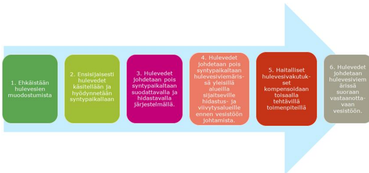
Bild 28. Prioritetsordning för hanteringen av dagvatten enligt Kyrkslätt dagvattenprogram (Sito Oy, 2017).
