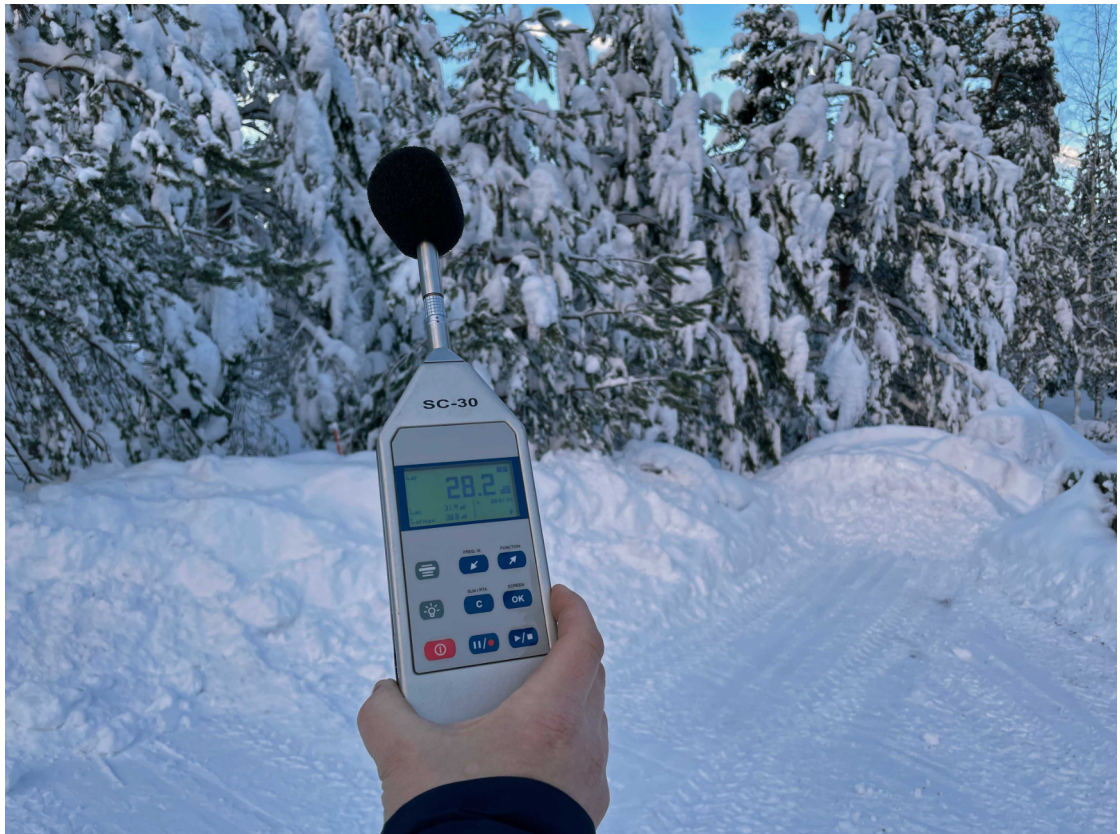
Kuva 4. Äänitasomittaus kiinteistöllä 1-90, 15.12.2022. Mittaussuunta kohti murskausaluetta.
