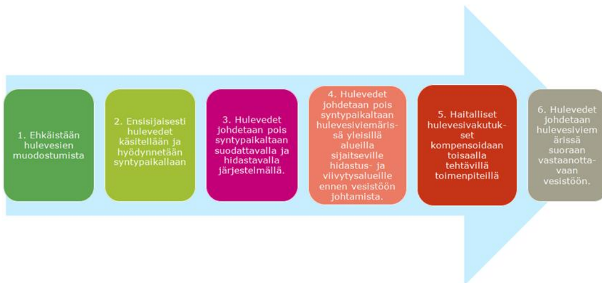
Bild 28. Prioritetsordning för hanteringen av dagvatten enligt Kyrksläts dagvattenprogram (Sito Oy, 2017).
