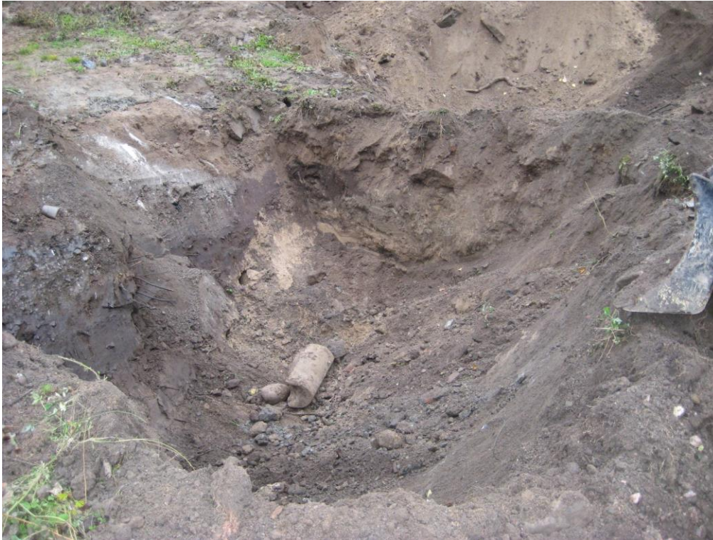
Kuva 3. Koekuoppa 1:n laajennuksesta löytynyt betoniputken pala.
