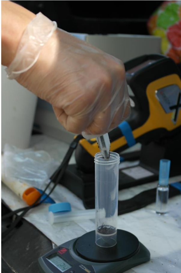
Kuva 2. Öljyhiilivetyjen määrittäminen Petroflag-menetelmällä. Kuvassa on meneillään tilanne savimaan punnitsemisesta. Taustalla näkyy metallien määrittämiseen käytettävä XRF-laitteisto.
