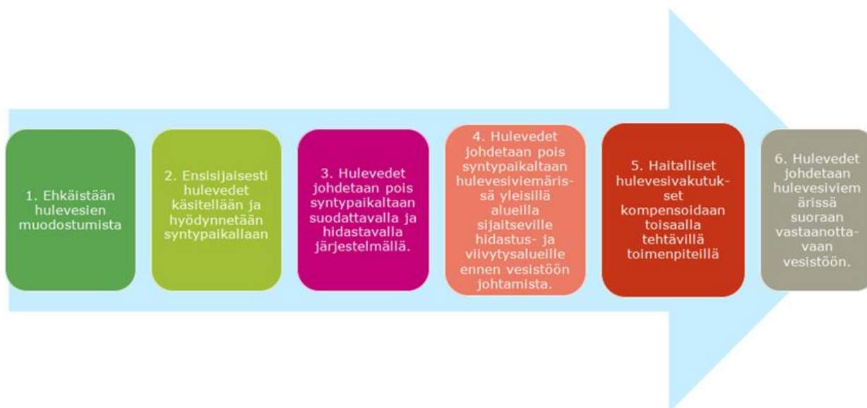
Bild 28. Prioritetsordning för hanteringen av dagvatten enligt Kyrkslätt's dagvattenprogram (Sito Oy, 2017).
