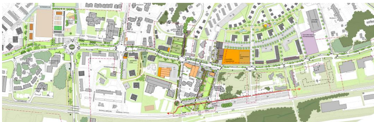
Bild 8. Utdrag ur kvalitets- och miljöplanen för Masaby (FCG Oy, 2017). Ur bilden framgår viljetillståndet gällande Masabyvägens trafiklösningar och miniresecentrets arrangemang med målet att möjliggöra smidiga omstigningar mellan olika kollektiva trafikmedel.
