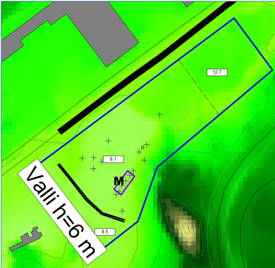
Kuva 4. Melulähteiden (M = murskain, R = rikotin, muut siniset ristit ovat muita työkoneita) sijainnit ja maastonmuodot (liite 3).
