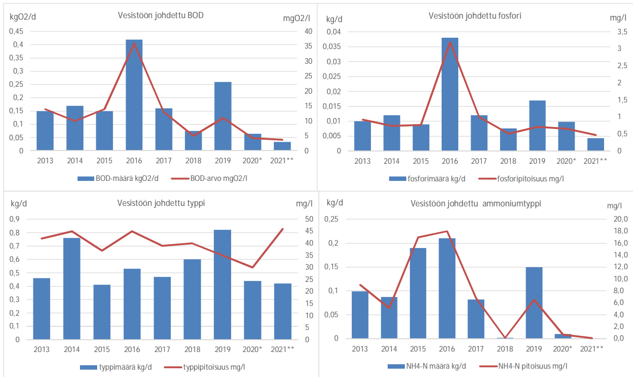
Kuva 4. Volsin puhdistamon vesistökuormitus
