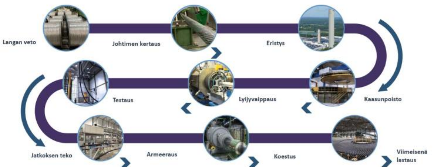
Kuva 1. Merikaapeleiden valmistuksen prosessikaavio.
