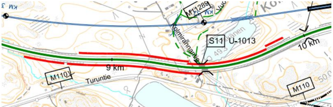
Kuva 5. Ote Turunväylän aluevarausuunnitelmasta (v. 2022), josta ilmenee ehdotetut meluntorjuntatoimenpiteet (yhtenäinen punainen viiva) Kirkkonummen ja Espoon rajavyöhykkeellä.
