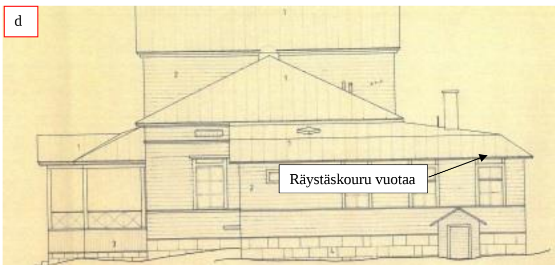
Kuvat 66 a-d. Sade- ja sulamisvesien ohjauksessa on puutteita kourujen osalta (a-d). Vesi ei ohjaudu kouruun ja kourun pää on avoin, jolloin vesi valuu julkisivulle (a) tai kouruja ei ole (b). Myös kourujen kallistuksissa ja tiiveydessä oli puutteita (c,d).
