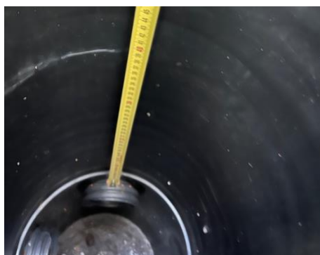
Tarkastetusta salaojakaivosta mitattuna salaojat sijaitsivat n. 35..40 cm syvyydessä maan pinnasta.
