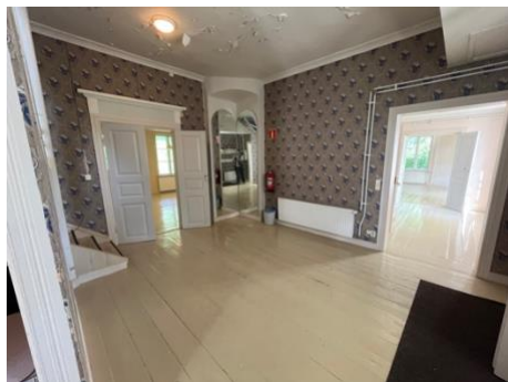
Alakerran sisätiloja. Katon maalipinta hilseilee. Kosteutta ei havaittu.
