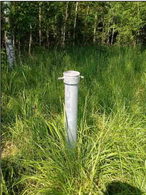
Kuva 18. Havaintoputki PVP-KN40 (havaintopiste HEL04_PV4) pinnankorkeuden mittauspäivänä 28.6.2023. / Standpipe PVP-KN40 (observation point HEL04_PV4) on the surface level observation day 28.6.2023.
