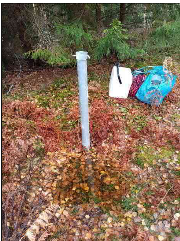
Kuva 20. Havaintoputki PVP-KN38 (havaintopiste HEL04_PV6) näytteenottopäivänä 12.10.2023. / Observation standpipe PVP-KN38 (observation point HEL04_PV6) on the sampling day 12.10.2023.
