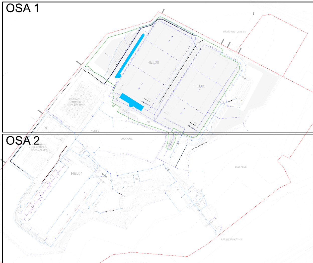
Kuva 2.4: Hankkeen kuvaus – Alustava rakentamisen aikainen työmaavesien hallintasuunnitelma (AECOM). Osat 1 ja 2 esitetty seuraavissa kuvissa lähempää. Bild 2.4: Projektbeskrivning – Preliminär dagvattenskontroll plan under byggskedet (AECOM). Del 1 och 2 visas närmare i följande bilder.
