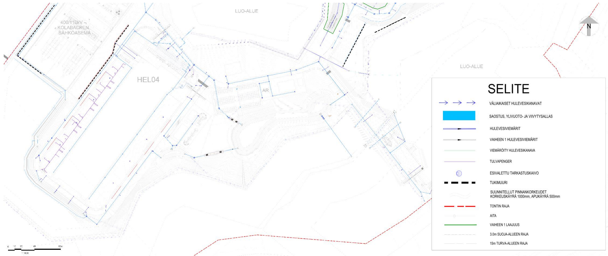
Kuva 2.6. Hankkeen kuvaus – Alustava rakentamisen aikainen työmaavesien hallintasuunnitelma (AECOM). OSA 2/2. Bild 2.6: Projektbeskrivning – Preliminär dagvattens kontrollplan under byggskedet (AECOM). DEL 2/2.
